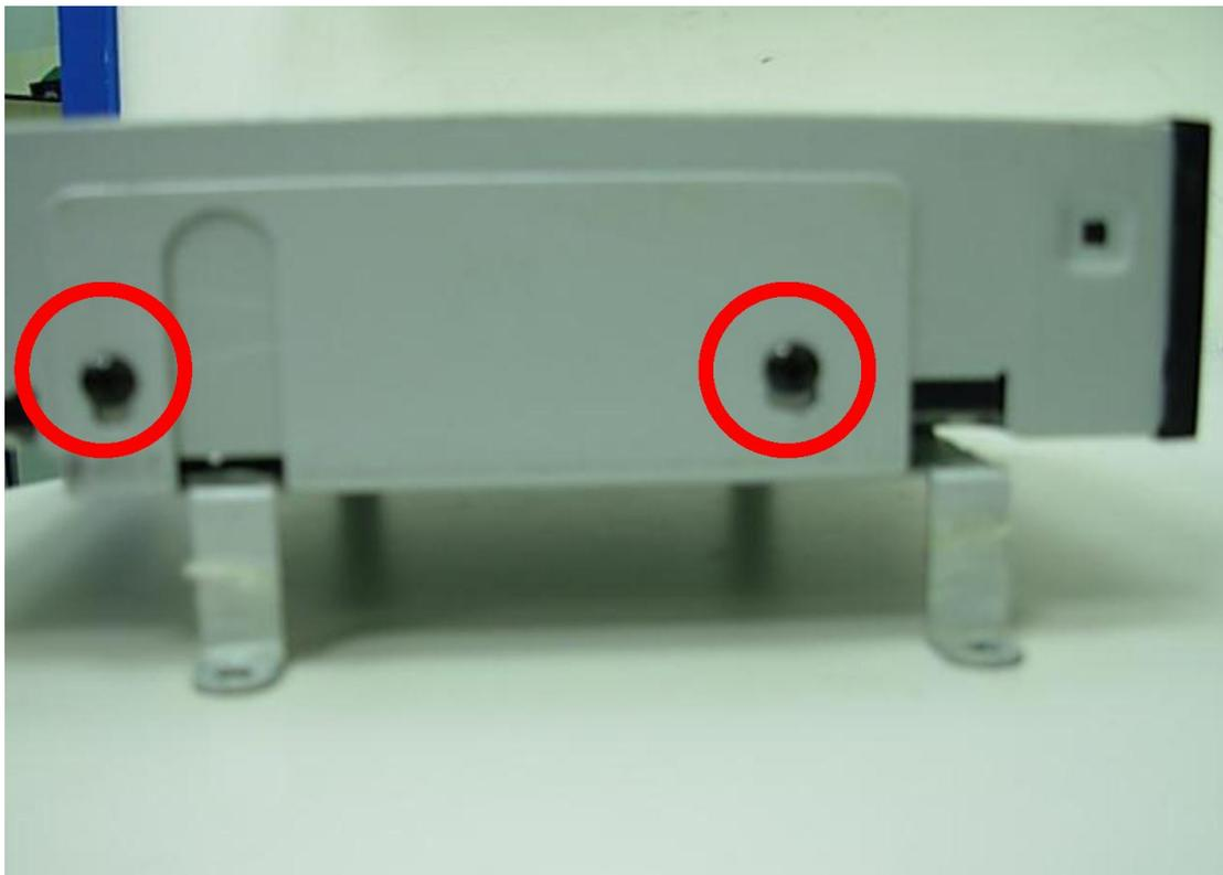
Шаг 3: Раскрутите устройство и снимите крышку как показано на рисунке:
