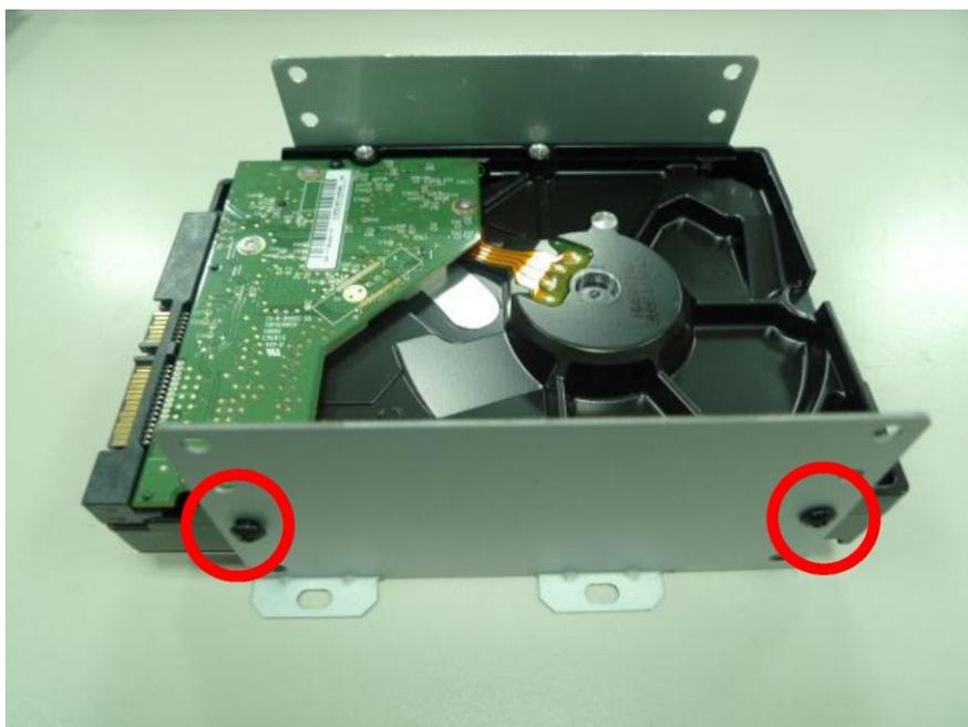
Шаг 2) Раскрутите устройство и снимите крышку как указано на рисунке:
